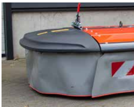
3. Copertura laterale flessibile FLEXPROTECT, ridisegnata e brevettata*
