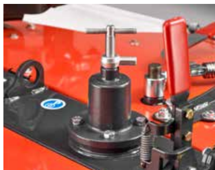
3. Regolazione continua dell'altezza di taglio
