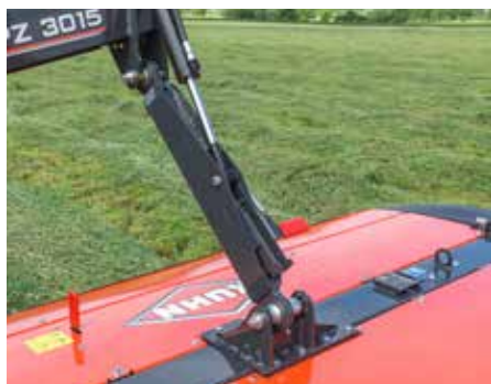
2. Testata con geometria del tirante
