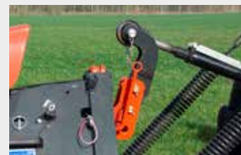
3°punto flessibile FLEXTOP (solo in combinazione con una testata di attacco fissa)
