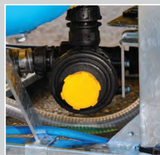
Filtro di aspirazione esterno con valvola antisvuotamento, predisposto per riempimento.
