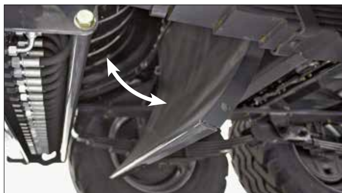
Portello d'ispezione della pre-camera
