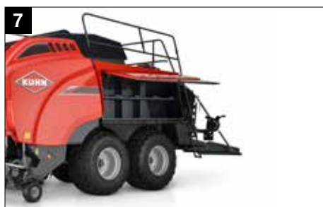
Contenitori per lo spago facilmente accessibili con una capacità di 2 x 16
