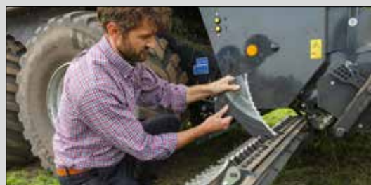
Sistema di coltelli a cassetta a scorrimento laterale
