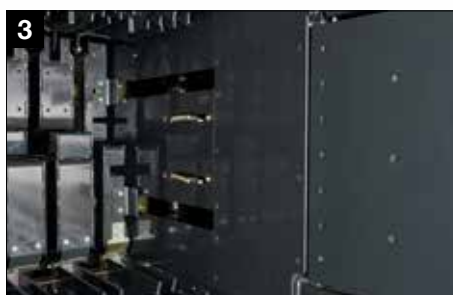
Componenti del canale balla sostituibili e resistenti all'usura.
