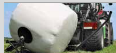
Ribaltatore balle, per scaricare la balle sulla faccia piana
