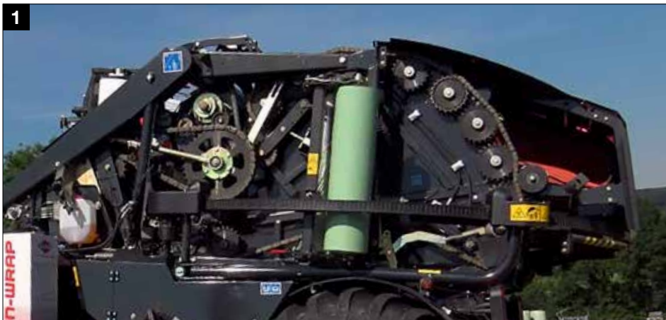
Trasmissione robusta tramite catene di alta qualità IWIS
