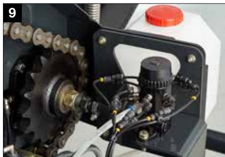
Sistema di lubrificazione catene in continuo BEKA-MAX
