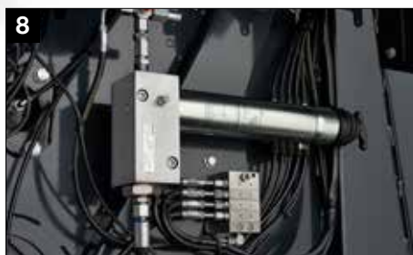
Sistema di lubrificazione automatico per i cuscinetti dei rulli di serie
