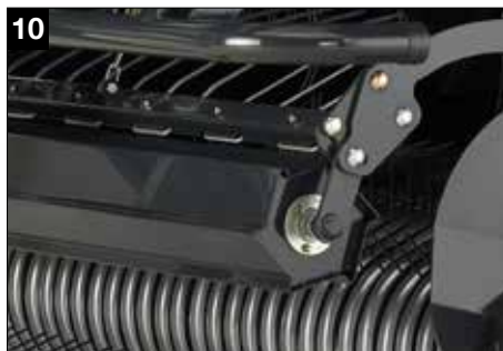
10 Rullo per foraggio pesante con paravento (Ø 217 mm)
