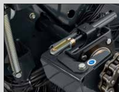
Disinnesto idraulico del rotore
