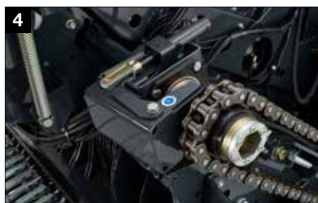
Disinnesto idraulico del rotore
