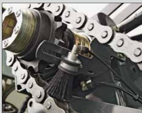
Spazzole di lubrificazione ampie e robuste
