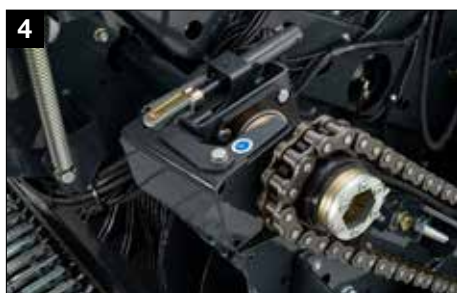
Disinnesto idraulico del rotore
