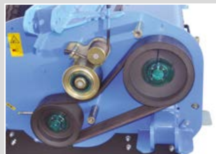
Tensionamento automatico delle cinghie per una costante trasmissione di potenza
