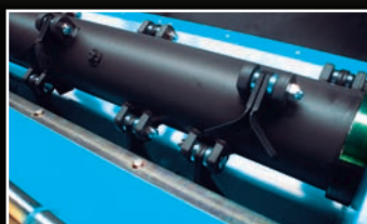
Coltelli spessore 8 mm con perno trattato. Rotore equilibrato dinamicamente ai massimi regimi di lavoro della macchina.
